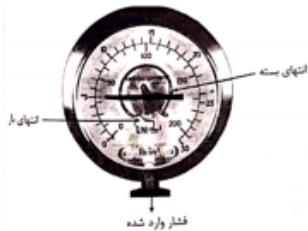
نکته: عدد نشان داده شده توسط عقربه فشارسنج بوردون، میزان بیشتر بودن فشار داخل لوله را نسبت به خارج آن (یعنی محیط قرارگیری فشارسنج) نشان می‌هد. حال اگر محیطی که فشارسنج در آن قرار دارد هوای آزاد باشد، در آن صورت فشارسنج بوردون، فشار نسبی را نشان خواهد داد.
